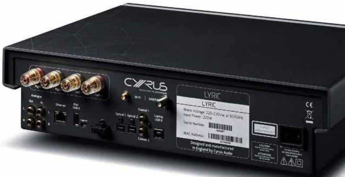
Unaufgeregt, doch stattlich. Hinter den Digital-Eingängen kann der Lyric 09 bis zu 24 Bit/192 kHz feinrastern. Hinter den Lautsprecherklemmen waltet ein „Speaker Impedanz Adjustment“, ein Einmessgenerator, der die optimale Impedanz für die Leistungsadressaten selbstständig erkennt. Die Kopfhörerbuchse verbirgt sich auf der Frontseite hinter der kleinen Klappe unten rechts.
